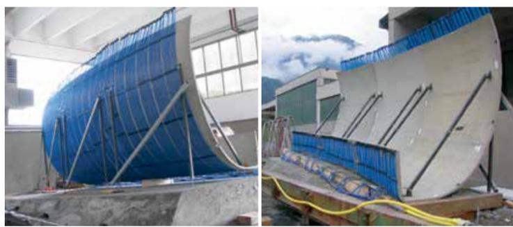
Dünne Wände ermöglichen eine effiziente und energieschonende Vereisung.
