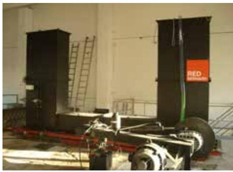
Versuchsanlage eines Flüssigkeitstilgers zur Dämpfung von Turmschwingungen
