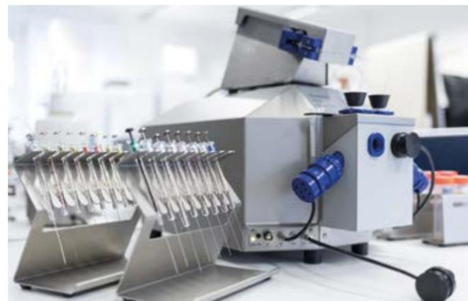
Mittels optischer Fluoreszenzmessungen kann der O2k unter anderem auch die Produktion von Sauerstoffradikalen und ATP, die Kalzium-Konzentration oder das mitochondriale Membran-Potenzial ermitteln.
