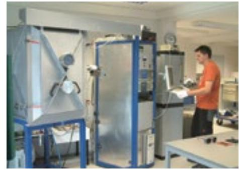
Beschichtungsanlage zur Herstellung von funktionellen Schichtsystemen
