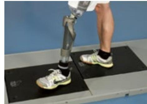
3D Kraftmessplatten im Walkway
